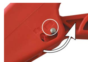
Инструмент переключен для работы с модулями Nexans snap-in старой модификации
