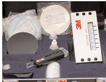
Набор для оконцовки волокна по технологии Hot Melt
